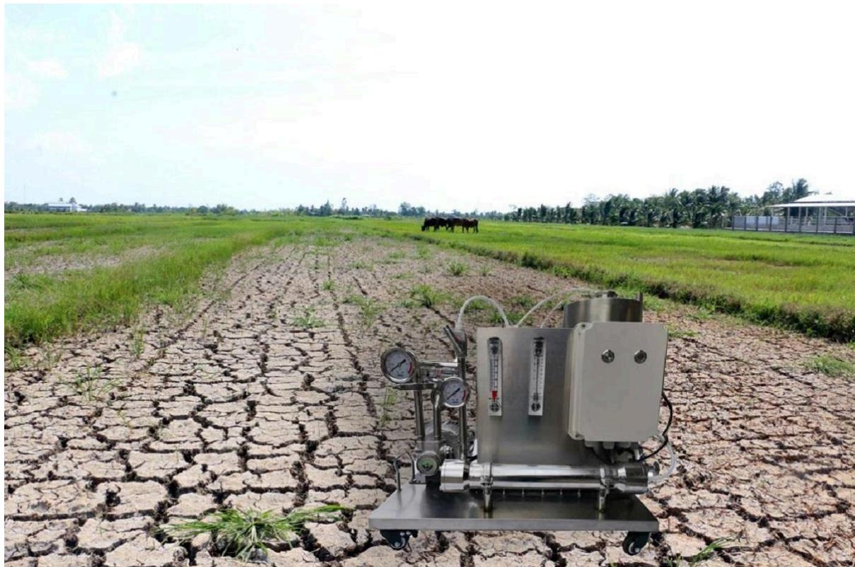
Máy lọc nước bằng phương pháp RO sử dụng một màng lọc để loại bỏ các tạp chất và vi sinh vật trong nước. Màng lọc này có độ xốp nhỏ, giúp loại bỏ hầu hết các tạp chất như muối và vi khuẩn trong nước mặn. Tuy nhiên, máy lọc RO có chi phí đầu tư cao hơn và cần điện năng để hoạt động. Để có thể vận hành hiệu quả, máy lọc RO cần được bảo trì và thay thế các bộ lọc định kỳ.
